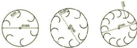
Gambar 2. Profile bilah cross flow pada tingkat kedua
